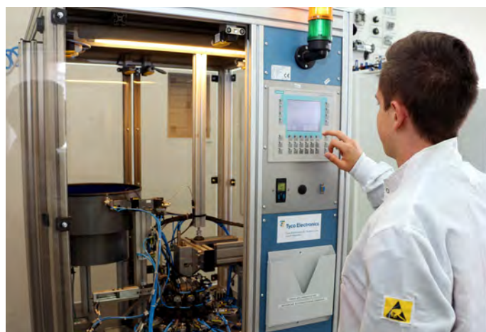
6. Automat na třídění kontaktů
