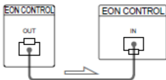
Obrázek 3-28 – Konektory pro ovládnání EON na radiopřijímači (OUT – radiopřijímač, IN – zesilovač)
