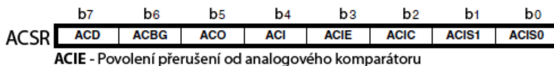
Obrázek 33 – (Analog Comparator Control Register) Řídící registr analogového komparátoru
